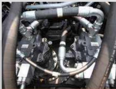
**A** ГИДРОМОТОР ПОВОРОТА
