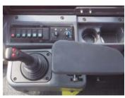
**Кабина** кабины имеет эргономическую конструкцию, в ней имеется большое место оператора, широкое переднее и заднее поля зрения, удобное и комфортное рабочее место, облегчающее работу оператора. Используется амортизирующая подушка новой модели, обеспечивающая большую прочность, снижение ударов и шума, эффективно снимающая усталость водителя.
